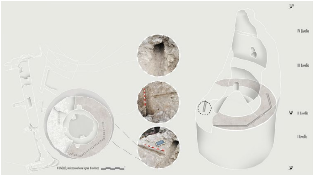
4: Cerreto antica (Cerreto Sannita, Benevento). Schema con indicazione della posizione dei rinforzi lignei disposti longitudinalmente alla muratura (Giacco, Iovine 2021).
