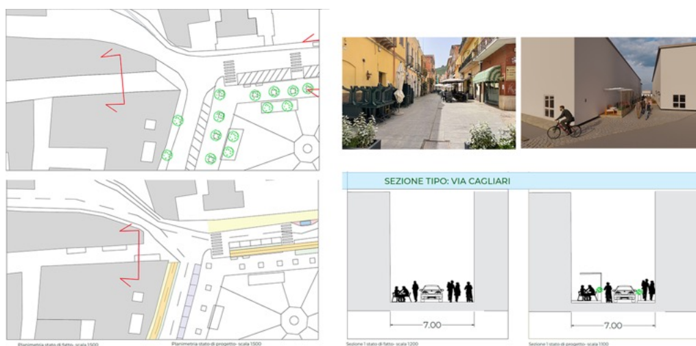
4: Centro Storico della Città di Iglesias. Proposta per una pista ciclabile in Via Cagliari: Piante e Sezioni, 2021.
