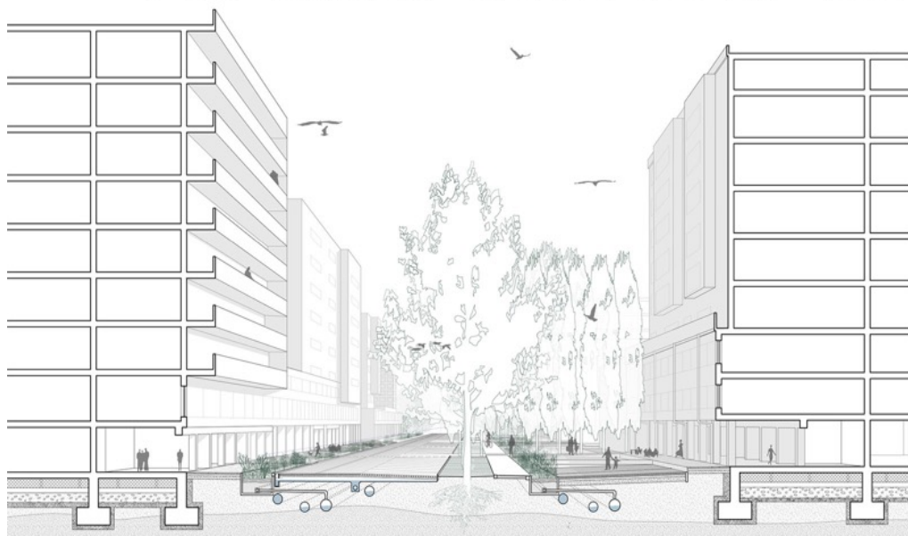
5: Padova. Un esteso progetto di suolo tra la ferrovia e il centro storico. Progetto di Aurora Calligher e Nicoletta Ros. Planimetria d'insieme e sezione prospettica su via delle Absidi con i dettagli delle nuove pavimentazioni e dei rain-gardens .
