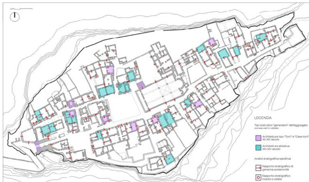
1: Isabella Zamboni, Civita di Bagnoregio, tipi costruttivi "generatori" dell'aggregato riconoscibili in elevato durante il rilievo stratigrafico speditivo, 2022 [rielaborazione da rilievo fornito da Archivio del Niaux Center, University of Washington, sede di Civita di Bagnoregio].
