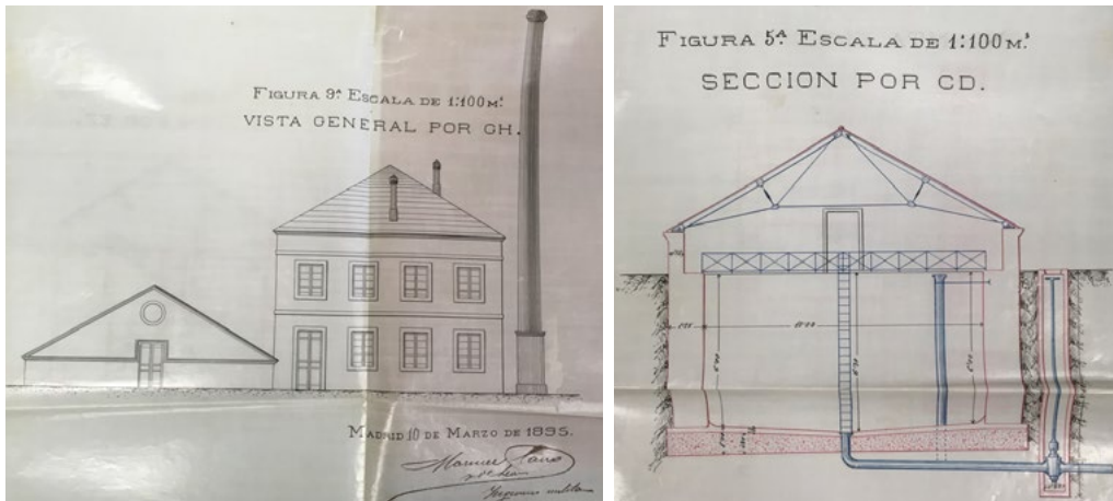
2-3: Manuel Cano y León, Proyecto de elevación y conducción de agua desde la acequia de riego del este a Chamartín (AHMF, Dirección General de Obras Públicas, Negociado de Agua, Canal Isabel II, lejtatos 366, tomo 3, Madrid 10 marzo 1895). Stralci della tavola di progetto illustrante il prospetto del complesso e la sezione trasversale del deposito per l'acqua.
