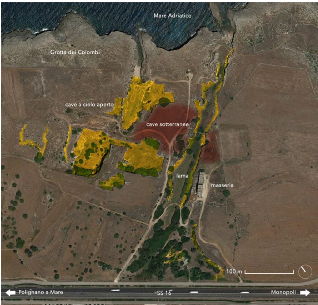
2: L'area delle cave di Pozzovivo a Polignano a Mare (BA). In giallo, le cave a cielo aperto e sottotecchia, in rosso le cave sotterranee. [Elaborazione: G. Germanò', su base Google Maps].
